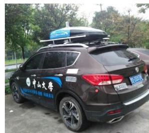
图 2 搭载了 Velodyne HDL-32E 激光雷达的东
